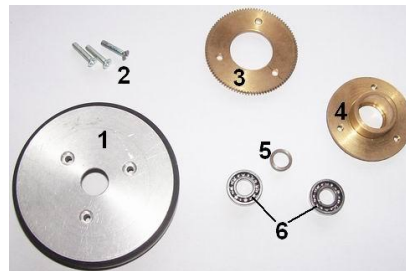
Obr 9 Kolo robota Century, 1 – pojezdové kolo i s pneumatikou, 2 – šrouby M2, které drží celek kola pohromadě, 3 – ozubené kolo, 4 – unašeč, 5 – mezikruží, 6 – ložiska.
